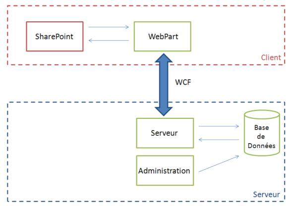
La communication entre les webparts et le serveur s'effectue via la technologie WCF (Windows Communication Foundation). C'est le nouveau protocole de communication client-serveur mis à disposition dans le Framework .NET 3.5. Basé sur les Services Web, .NET Remoting, Microsoft Transaction Server, et Microsoft Message Queuing. Il à l'avantage de proposer une certaine stabilité durant la communication entre les composants et une grande facilité de développement.
